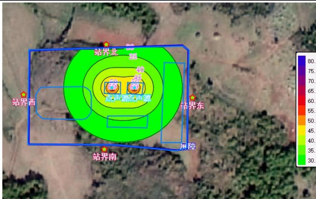
图 4-4 220kV 升压站噪声等声级线图
